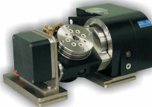
Tavole adatte all'utilizzo su macchine EDM per eseguire lavorazioni in completa immersione in liquido dielettrico. Principali caratteristiche: Struttura interamente costruita con materiali anti-ossidanti (inox e lega) Precisioni di posizionamento fino a 2,5 sec. con encoder in asse. Motori brushless digitali a bassa tensione Carter a tenuta stagna mediante guarnizioni o-ring Predisposizione per fissaggio dei mandrini porta pallet più diffusi Possibilità di gestione mediante CN LCM WNC 50 2AX®.
