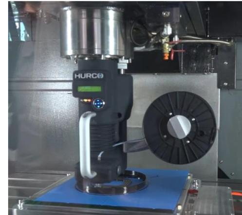
Software che permette la gestione a bordo macchina della **testina per la stampa in 3D** del pezzo programmato in conversazionale o iso direttamente dal CNC.
